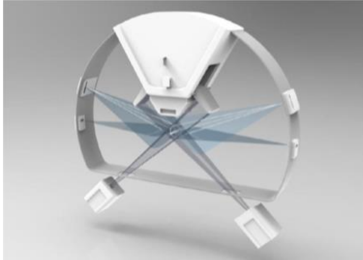
图 3-16 旋转束治疗室 X 射线管位置示意图
